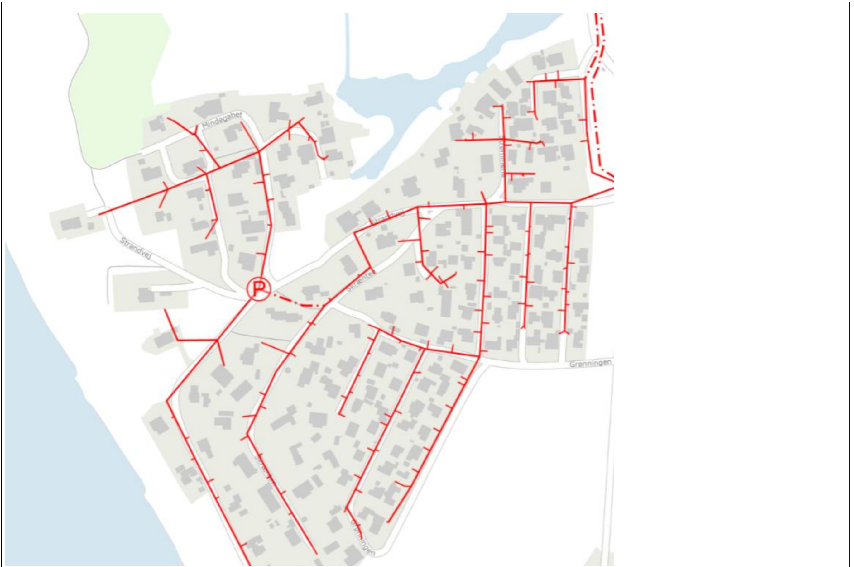
Enø Strand Kloak ledninger
